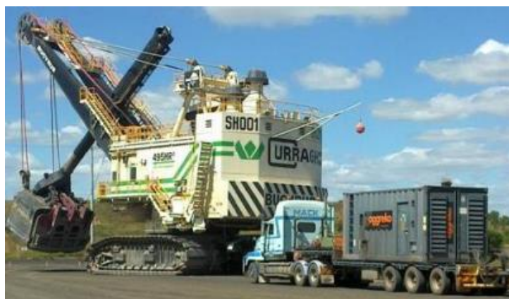
Imagen 2: Soporte Operación Minera – Generador ISO20”
