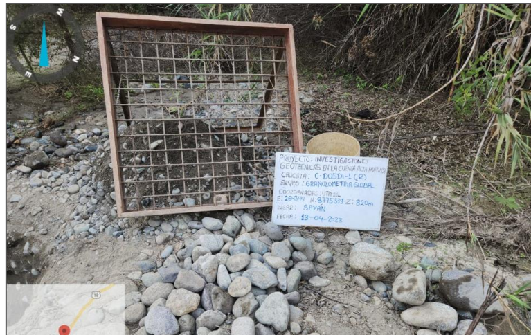
Figura 4.1. Foto referencial del ensayo de granulometría global
